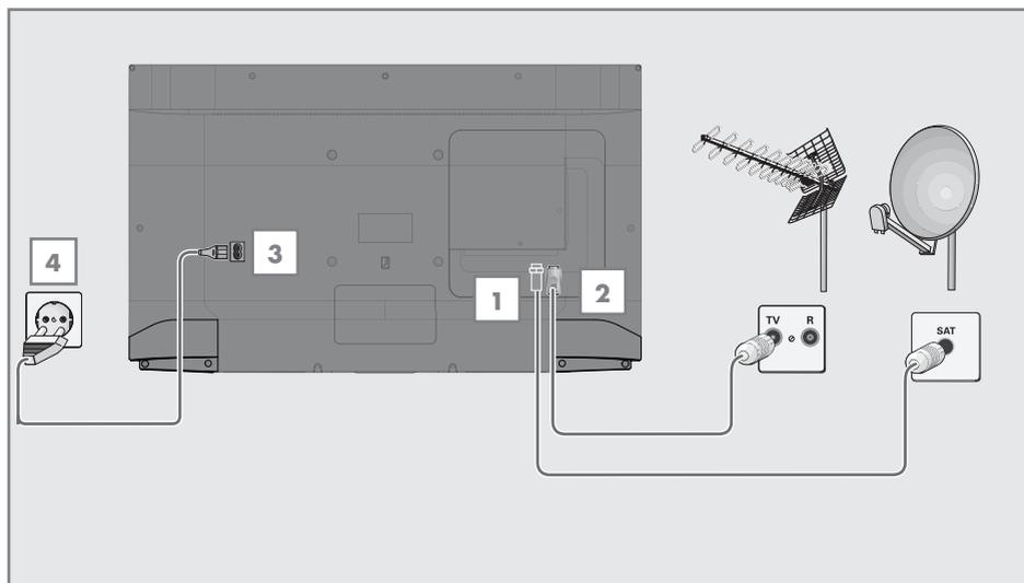
**1** Za prijam digitalnih satelitskih kanala (DVB-S) povežite satelitski antenski kabel na utičnicu antene **SATELLITE** na TV prijarniku.
